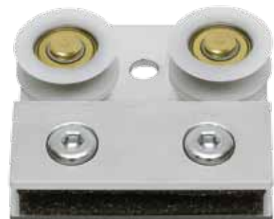
2126 D40 Roldana Dupla p/ Trilho P-68 e P-373 (40mm entre furos)
