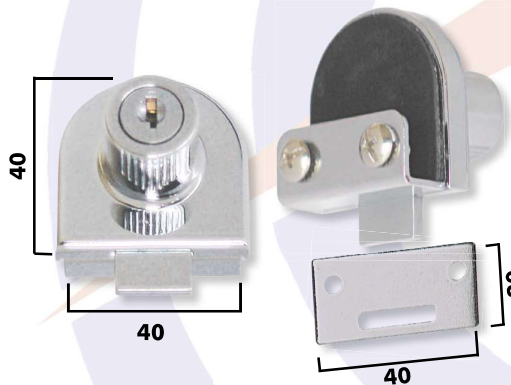
1520 R Fechadura para Rack Pressão Porta Simples Mini Montagem em vidros de 8 e 6mm Disponível somente no acabamento cromado
